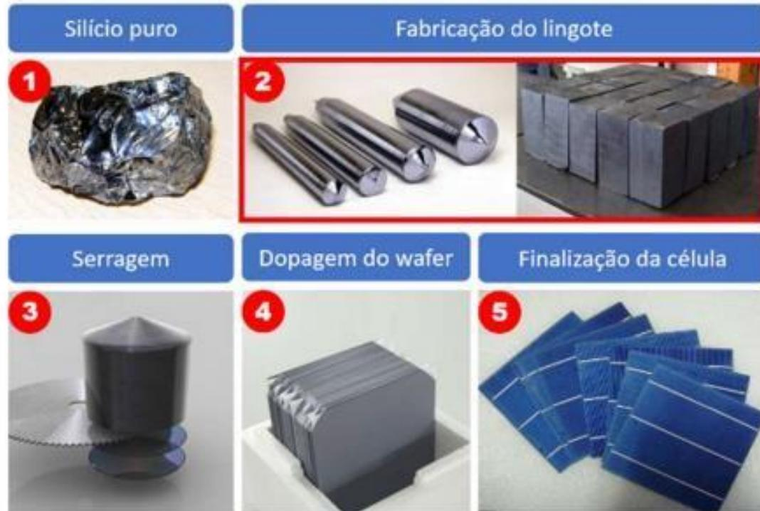
O processo de fabricação de uma célula fotovoltaica cristalina (mono ou poli) começa com a produção do lingote monocristalino ou policristalino (etapa 2), de onde são extraídos os wafers pelo processo de serragem. Os wafers depois são dopados e vão se transformar em células.
