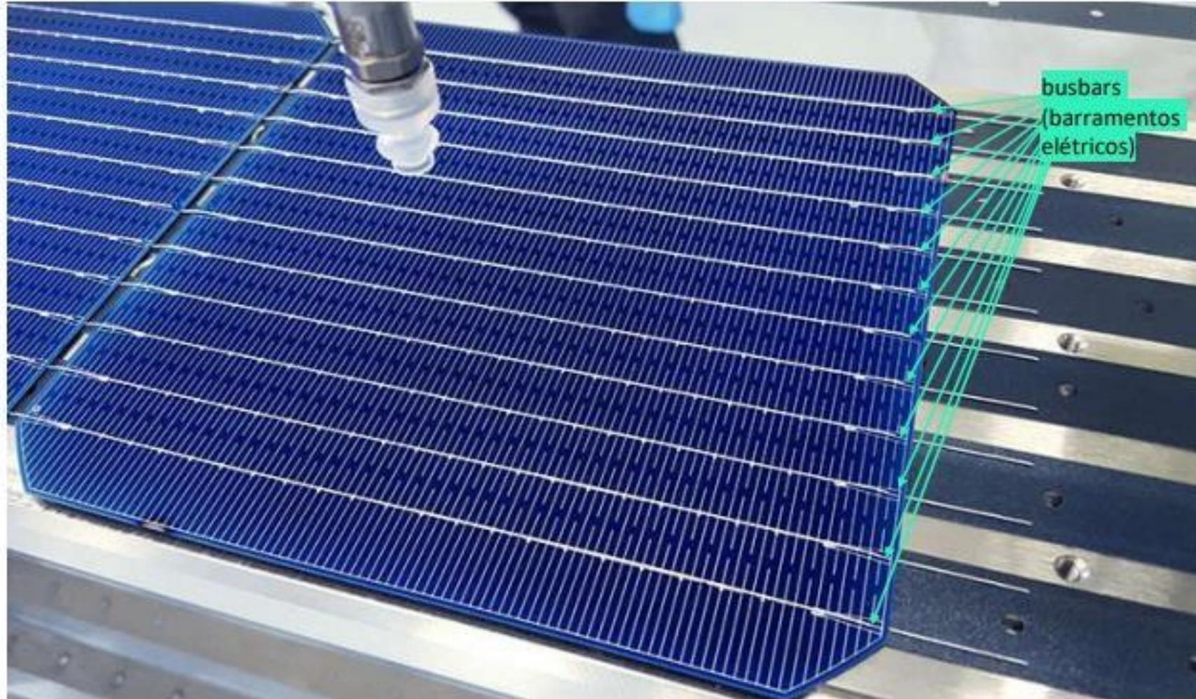
Os módulos FV eram tradicionalmente fabricados com células 3BB, 4BB ou 5BB (*busbars*).
