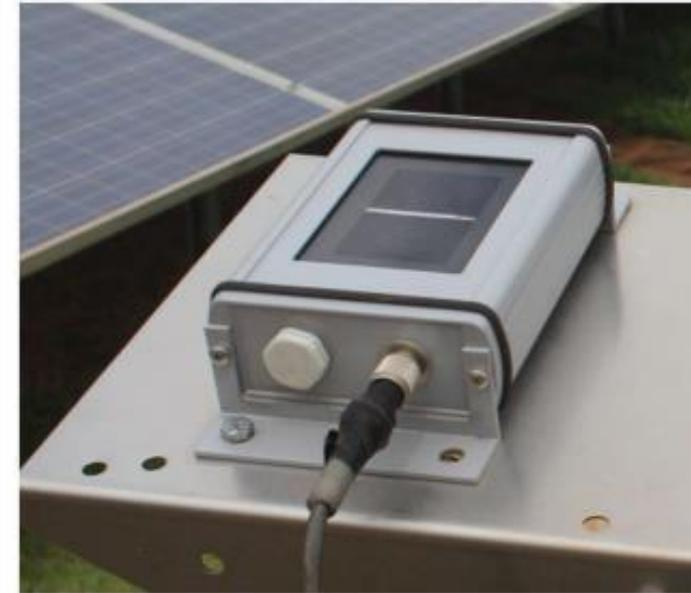
**Célula fotovoltaica de precisão:** célula fotovoltaica calibrada, usada para medições da irradiância em sistemas de monitoramento. Tem uma resposta espectral inferior à do piranômetro e do pireliômetro.
