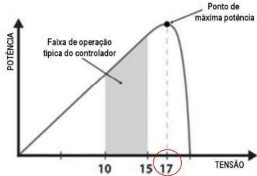
Com MPPT o painel solar opera exatamente na tensão necessária (máxima potência)
