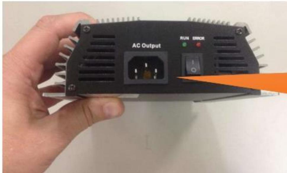
Saída de corrente alternada (CA) (110V, 220V, etc) – conexão dos aparelhos que serão alimentados (TV, lâmpadas, computador, etc)
